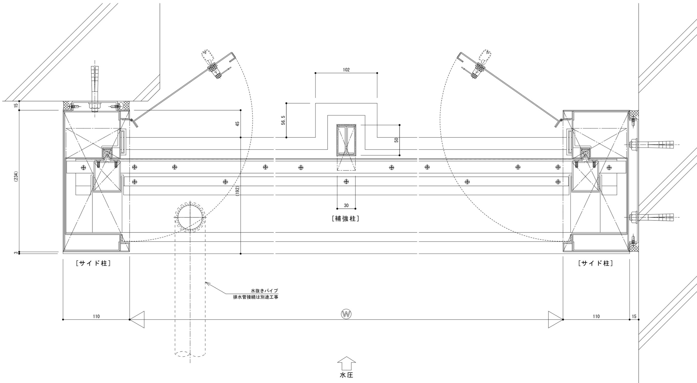
※ ( ) 寸法はW寸法、H寸法、補強柱数、補強バー数により変動
