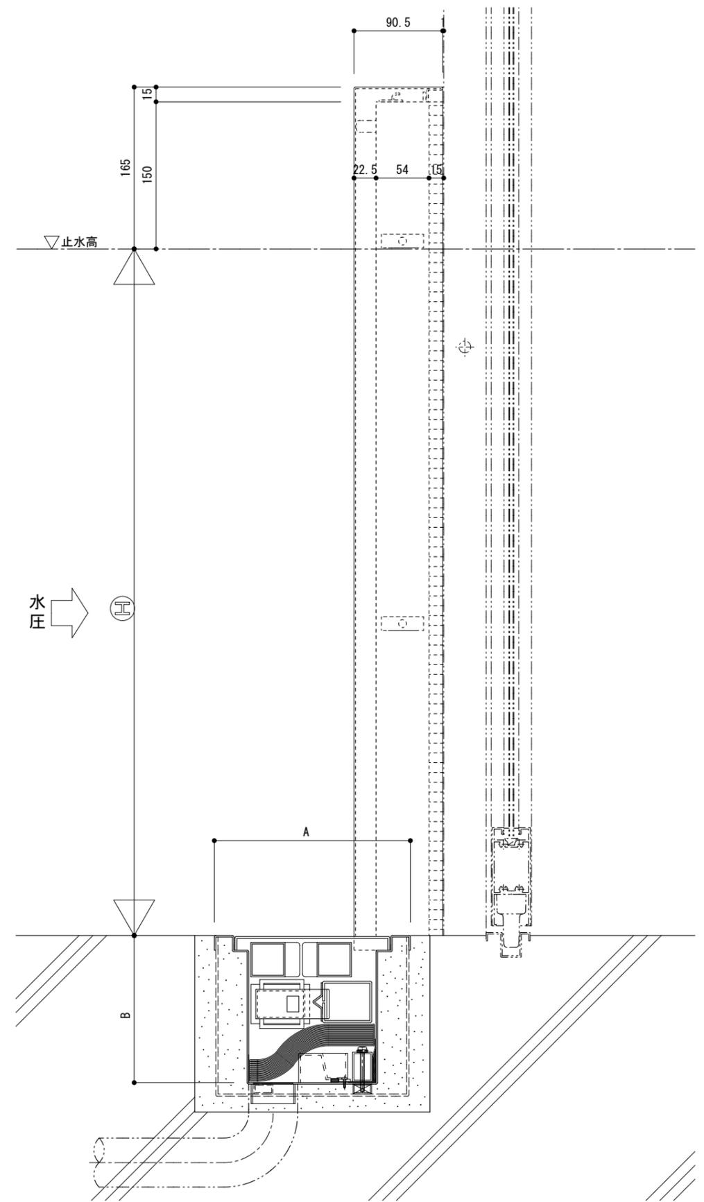
※A, B寸法はW寸法、H寸法、補強柱数、補強バー数により変動
