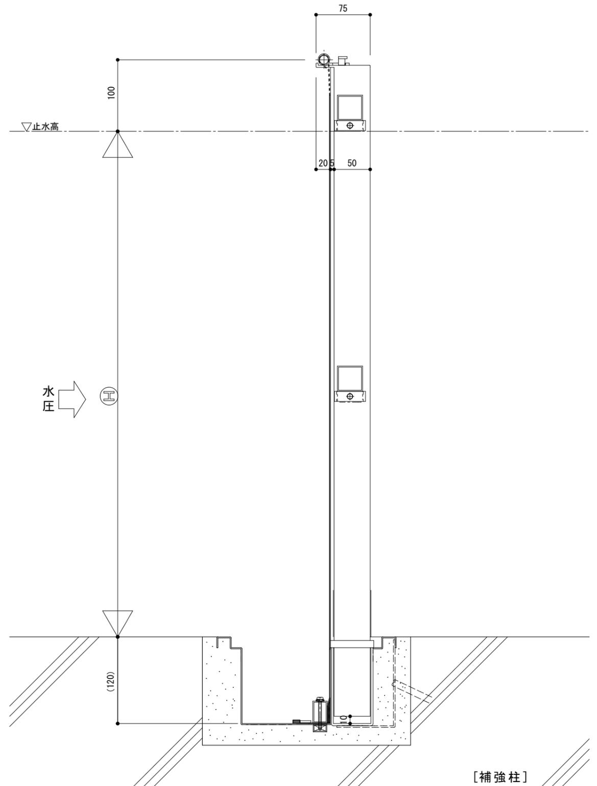
※ ( ) 寸法はW寸法、H寸法、補強柱数、補強バー数により変動
